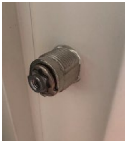
3. Připevněte tělo zámku na zadní straně dveří.
