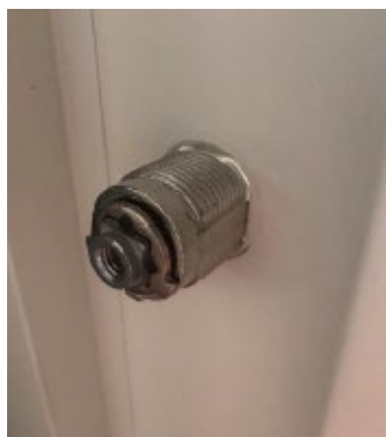
3. Pripevnite telo zámku na zadnej strane dverí.
